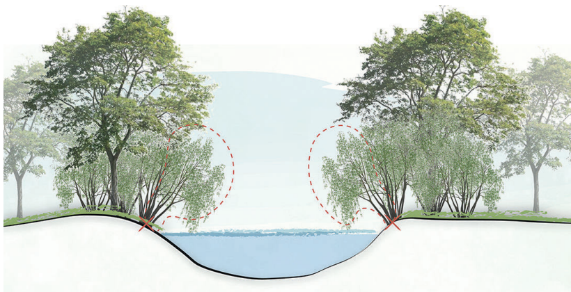
Figura n.º 7: Corte seletivo de ramos ou exemplares de forma a repor uma secção hidráulica adequada (adaptado de Jund et al., 2000).
