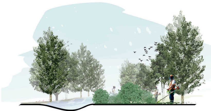
Figura n.º 20 – Corte de silvas nas margens (que não comprometa a estabilidade de taludes, caso existam) com recurso a motorroçadora, com trituração dos resíduos, com recurso a disco.
